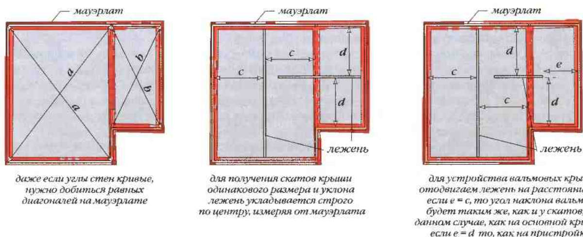
Рис. 47. Разметка мауэрлата и лежня
