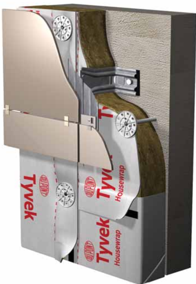
Рис. 9 Система навесных вентилируемых фасадов
